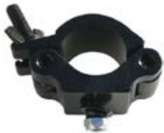
Coupler Sencilla para Tubo de EVB-P-7740 Material: Aluminio en plata y negro Tubos: 48mm a 51mm de Ø Carga límite: Hasta 500 Kg Marca: Kupo
