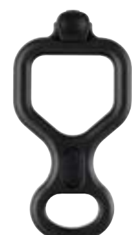
Huit Antibrulure DCDPZ-D01 Descensor en ocho con protección anti quemaduras Color: Negro Ø de Cuerda: 8 a 13 mm Marca: Petzl
