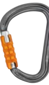
William MQPZ-M36ATL Mosquetón asimétrico ligero de gran capacidad Sistema de Bloqueo: Triact-lock Material: Aluminio Color: Negro Peso: 90g Abertura: 27mm Resistencia eje mayor: 27KN Marca: Petzl
