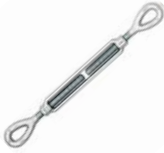
Crosby HG-226 Eye&Eye Turnbuckles ETCR-HG-226 Tensor ojo: Ojo de acero galvanizado Disponible: 1/4"x 4" a 2 3/4"x 24" Carga límite: 75,000 lbs Marca: Crosby
