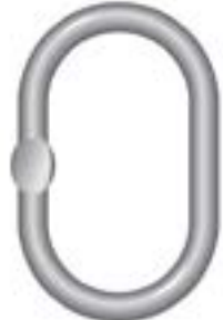
Anilla Maestra Excel ECVB-MS Eslabón maestro Material: Acero aleado, grado 8 Carga límite: Hasta 125 Ton Medida: 13 a 80 mm Marca: Van Beest
