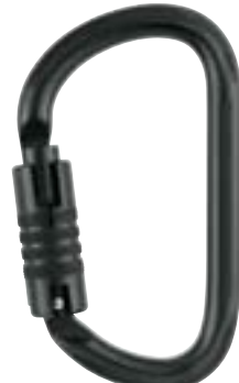
Vulcan MQPZ-M73 TLN Mosquetón asimétrico de alta resistencia y gran capacidad Sistema de Bloqueo: Triact-lock Material: Acero Color: Negro Peso: 305g Abertura: 27mm Resistncia eje mayor: 40KN Marca: Petzl
