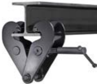
Beam Clamp de Cangrejo BEAMCLAMP-C Abrazadera para viga Apertura: 3" a 8" / 3" a 9" / 3.2" a 12.6" Carga límite: 1 a 3 Ton. Factor de Seguridad: 5:1
