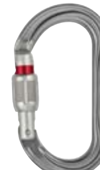
OK MQPZ-M33ASL Mosquetón oval ligero Sistema de Bloqueo: Screw-lock Material: Aluminio Color: Gris Peso: 70g Abertura: 22mm Resistencia eje mayor: 25KN Marca: Petzl
