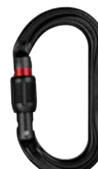
OK MQPZ-M33ASLN Mosquetón oval ligero Sistema de Bloqueo: Screw-lock Material: Aluminio Color: Negro Peso: 70g Abertura: 22mm Resistencia eje mayor: 25KN Marca: Petzl
