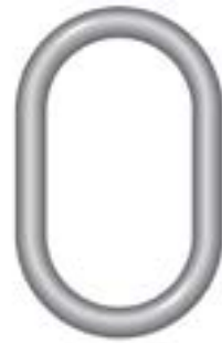
Anilla Maestra DNV ECVB-DNV Eslabón maestro Material: Acero aleado, grado 8 Carga límite: Hasta 85 Ton Medida: 16 a 70 mm Marca: Van Beest
