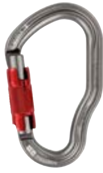
Vertigo Twist-Lock MQPZ-M40ARLA Mosquetón para elemento de amarre de progresión Sistema de Bloqueo: Twist-lock Material: Aluminio Peso: 100g Abertura: 25mm Resistncia eje mayor: 25N Marca: Petzl
