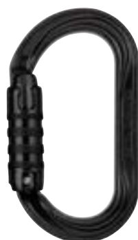
Oxan MQPZ-M72 ATLN Mosquetón oval de alta resistencia Sistema de Bloqueo: Triact-lock Material: Acero Color: Negro Peso: 195g Abertura: 20mm Resistncia eje mayor: 38KN Marca: Petzl
