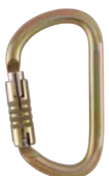
Vulcan MQPZ-M73 TL Mosquetón asimétrico de alta resistencia y gran capacidad Sistema de Bloqueo: Triact-lock Material: Acero Color: Dorado Peso: 285g Abertura: 28mm Resistncia eje mayor: 40KN Marca: Petzl
