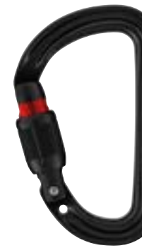
Sm´D MQPZ-M39ASLN Mosquetón asimétrico ultraligero Sistema de Bloqueo: Screw-lock Material: Aluminio Color: Negro Peso: 45g Abertura: 20mm Resistencia eje mayor: 23KN Marca: Petzl
