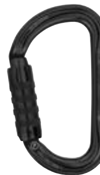
Am´D MQPZ-M34ATLN Mosquetón asimétrico ligero Sistema de Bloqueo: Triact-lock Material: Aluminio Color: Negro Peso: 75g Abertura: 24mm Resistencia eje mayor: 27KN Marca: Petzl
