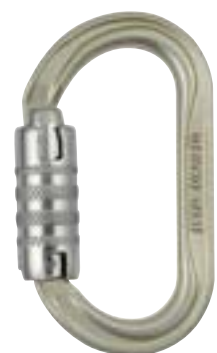
Oxan MQPZ-M72 ATLA Mosquetón oval de alta resistencia Sistema de Bloqueo: Triact-lock Material: Acero Color: Dorado Peso: 195g Abertura: 20mm Resistncia eje mayor: 38KN Marca: Petzl
