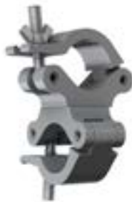
Coupler Doble para Tubo de EVB-P-7740 Material: Aluminio en plata y negro Tubos: 48mm a 51mm de Ø Carga límite: Hasta 500 Kg Marca: Kupo
