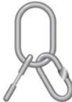
Anilla Triple Excel ECVB-MTS Eslabón maestro Material: Acero aleado, grado 8 Carga límite: Hasta 100 Ton Medida: 16 a 80 mm Marca: Van Beest
