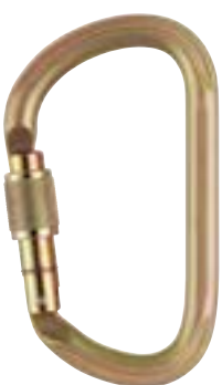
Vulcan MQPZ-M73 SL Mosquetón asimétrico de alta resistencia y gran capacidad Sistema de Bloqueo: Screw-lock Material: Acero Color: Dorado Peso: 265g Abertura: 29mm Resistncia eje mayor: 40KN Marca: Petzl
