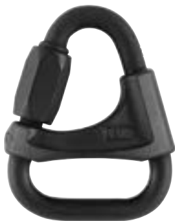
Delta MQPZ-P11 8BN Maillón de acero, forma triangular Material: Acero Color: Negro Peso: 95g Diámetro: 8mm Resistncia eje mayor: 25KN Marca: Petz
