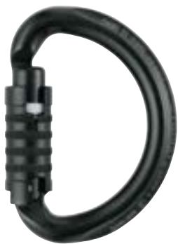
Omni MQPZ-M37TLN Mosquetón con gancho de frenado para descensor Sistema de Bloqueo: Triact-lock Material: Aluminio Color: Negro Peso: 90g Abertura: 22mm Resistncia eje mayor: 20KN Marca: Petzl
