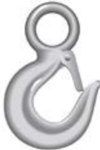
Gancho de Ojo Grande Green Pin ECVB-P-6714C Material: Acero aleado, grado 4 Abertura: 20mm hasta 48mm Carga límite: Hasta 5 Ton Marca: Van Beest
