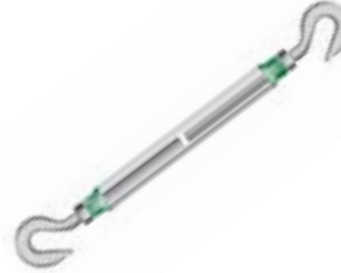
Tensor Green Pin Hook&Hook ETVB-G-6312 Tensor gancho: Gancho Disponible: 3/8"x 6" a 1"x 24" Carga límite: 2.27 Ton. Marca: Van Beest
