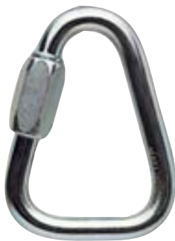
Delta MQPZ-P11 Maillón de acero, forma triangular Material: Acero Color: Gris Peso: 150g Diámetro: 110mm Resistncia eje mayor: 25KN Marca: Petz
