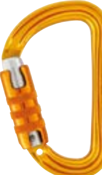
Sm´D MQPZ-M39ATL Mosquetón asimétrico ultraligero Sistema de Bloqueo: Triact-lock Material: Aluminio Color: Amarillo Peso: 55g Abertura: 18mm Resistencia eje mayor: 23KN Marca: Petzl
