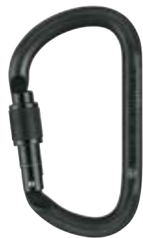
Vulcan MQPZ-M73 SLN Mosquetón asimétrico de alta resistencia y gran capacidad Sistema de Bloqueo: Screw-lock Material: Acero Color: Negro Peso: 265g Abertura: 29mm Resistncia eje mayor: 40KN Marca: Petz
