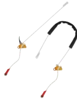
Grillon CEPZ-L52A Elemento de amarre regulable de sujeción Longitudes: 2, 3, 4, y 5 m Peso: 435, 515, 595 y 675g Marca: Petzl
