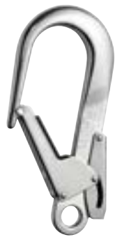
Mgo 110 MQPZ-MG0060 Conector direccional de gran abertura y bloqueo de seguridad Sistema de Bloqueo: Automático Peso: 940g Abertura: 110mm Resistncia eje mayor: 23KN Marca: Petz
