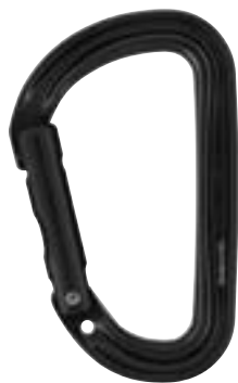
Sm´D MQPZ-M39ASN Mosquetón asimétrico ultraligero Sistema de Bloqueo: Sin sistema Material: Aluminio Color: Negro Peso: 40g Abertura: 23mm Resistencia eje mayor: 23KN Marca: Petzl
