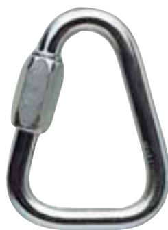
Delta MQPZ-P11 8 Maillón de acero, forma triangular Material: Acero Color: Gris Peso: 85g Diámetro: 8mm Resistncia eje mayor: 25KN Marca: Petz
