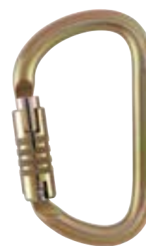
Vulcan MQPZ-M73 TL Mosquetón asimétrico de alta resistencia y gran capacidad Sistema de Bloqueo: Triact-lock Material: Acero Color: Dorado Peso: 305g Abertura: 27mm Resistncia eje mayor: 40KN Marca: Petzl
