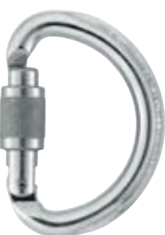
Omni MQPZ-M37SL Mosquetón con gancho de frenado para descensor Sistema de Bloqueo: Screw-lock Material: Aluminio Color: Gris Peso: 85g Abertura: 22mm Resistncia eje mayor: 20KN Marca: Petzl
