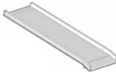
Rampas de aluminio RAMPA Superficie antideslizante Disponible: 6'x29', 8'x29', 12'x29', 14'x29' Carga límite: 1,600 lbs. Rieles laterales: 1 1/4"
