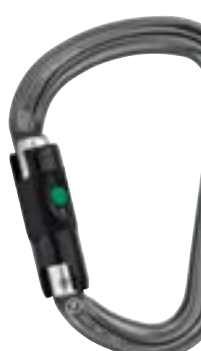
William MQPZ-M36ABL Mosquetón asimétrico ligero de gran capacidad Sistema de Bloqueo: Ball - lock Material: Aluminio Color: Gris Peso: 90g Abertura: 27mm Resistencia eje mayor: 27KN Marca: Petzl
