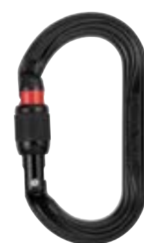
Oxan MQPZ-M72 ASLN Mosquetón oval de alta resistencia Sistema de Bloqueo: Triact-lock Material: Acero Color: Negro Peso: 195g Abertura: 20mm Resistncia eje mayor: 38KN Marca: Petzl
