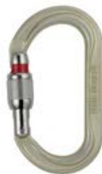
Oxan MQPZ-M72 ASL Mosquetón oval de alta resistencia Sistema de Bloqueo: Screw-lock Material: Acero Color: Dorado Peso: 195g Abertura: 22mm Resistncia eje mayor: 38KN Marca: Petzl
