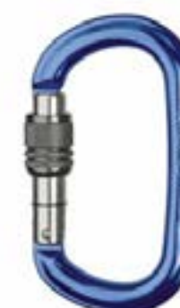
Ozone MQSR-K0016AA00 Mosquetón oval Sistema de Bloqueo: Screw Material: Aluminio Color: Azul Peso: 80g Abertura: 21mm Resistencia eje mayor: 26KN Marca: Singing Rock
