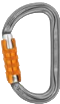
Am´D MQPZ-M34ATL Mosquetón asimétrico ligero Sistema de Bloqueo: Triact-lock Material: Aluminio Color: Gris Peso: 75g Abertura: 24mm Resistencia eje mayor: 27KN Marca: Petzl
