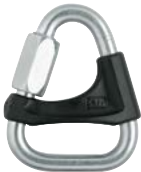
Delta MQPZ-P11 8B Maillón de acero, forma triangular Material: Acero Color: Gris Peso: 95g Diámetro: 8mm Resistncia eje mayor: 25KN Marca: Petz
