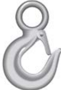
Gancho de Ojo Grande Green Pin ECVB-P-6714A Material: Acero aleado, grado 8 Abertura: 20mm hasta 77mm Carga límite: Hasta 22 Ton Marca: Van Beest
