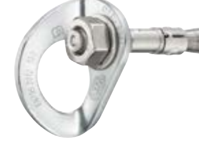
Coeur Bolt HCR WSPZ-P36BH12 Anclaje de acero inoxidable de alta resistencia a la corrosión para ambientes ultracorrosivos Diámetro: 12mm Peso: 145g Resistencia: 25 KN Paquete: 20 Piezas Marca: Petzl
