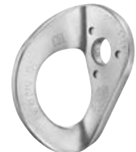
Coeur Steel WSPZ-P36AA10 Plaqueta de acero estándar para uso en interiores o trabajos puntuales Diámetro: 10mm Peso: 65g Resistencia: 25 KN Paquete: 20 Piezas Marca: Petzl
