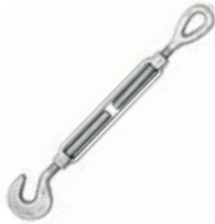
Crosby HG-225 Hook& Eye Turnbuckles ETCR-HG-225 Tensor gancho: Ojo de acero galvanizado Disponible: 1/4"x 4" a 1"x 12" Carga límite: 5,000 lbs Marca: Crosby
