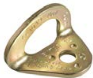
Hanger Plate/Zinc-Coated steel WSSR-RK704XX10 Anillo de fijación diseñado para dos mosquetones Diámetro: 10mm Peso: 45g Resistencia: 25 KN Marca: Singing Rock
