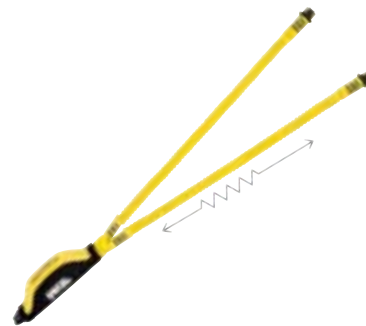
Absorbica Y Versión Europea CEPZ-L64YA Elemento de amarre doble con absorbedor de energía Conector: Sin Conector Materiales: Poliéster, Poliamida, Polietileno Longitudes: 80 y 150 cm Peso: 370 y 430 g Marca: Petzl
