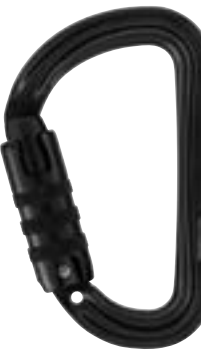
Sm´D MQPZ-M39ATLN Mosquetón asimétrico ultraligero Sistema de Bloqueo: Triact-lock Material: Aluminio Color: Negro Peso: 55g Abertura: 23mm Resistencia eje mayor: 23KN Marca: Petzl
