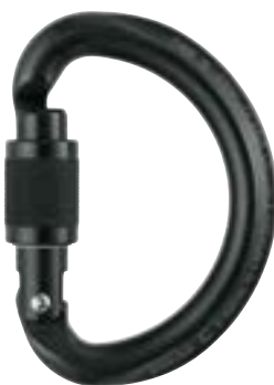
Omni MQPZ-M37SLN Mosquetón con gancho de frenado para descensor Sistema de Bloqueo: Screw-lock Material: Aluminio Color: Negro Peso: 85g Abertura: 22mm Resistncia eje mayor: 20KN Marca: Petzl
