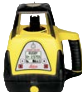
Leica Rugby 320SG LNLE-RUGBY 320SG Láser: Inclinación ejes x,y -5 a +25% Ajuste: inclinación tiempo real Rayo láser visible (rojo) Marca: Leica Geosystems
