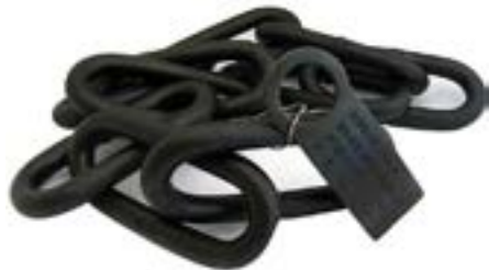
Deck Alloy Chain DECKCHAIN Cadena de 1/2" de Ø Uso: Suspensiones temporales de objetos Factor diseño: 4.1 W.L.L. 12,000 LBS
