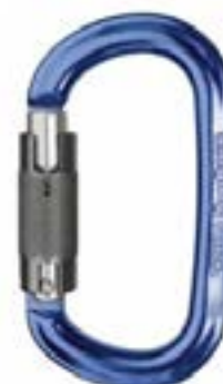
Ozone MQSR-K0017AA00 Mosquetón oval Sistema de Bloqueo: Twist-lock Material: Aluminio Color: Azul Peso: 85g Abertura: 21mm Resistencia eje mayor: 26KN Marca: Singing Rock
