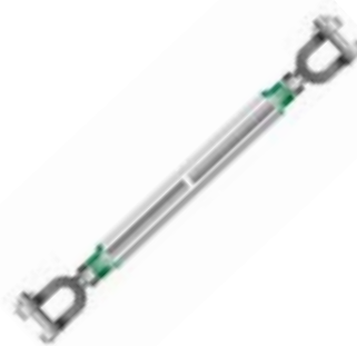
Tensor Green Pin Jaw&Jaw ETVB-G-6313 Tensor quijada: Quijada Disponible: 3/4"x 6" a 2 3/4"x 24" Carga límite: 34 Ton. Marca: Van Beest
