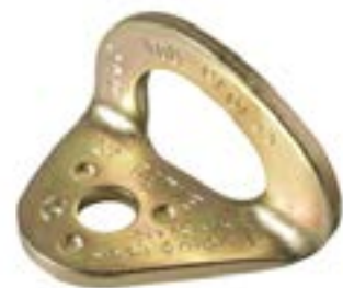
Hanger Plate/Zinc-Coated steel WSSR-RK704XX12 Anillo de fijación diseñado para dos mosquetones Diámetro: 12mm Peso: 45g Resistencia: 25 KN Marca: Singing Rock
