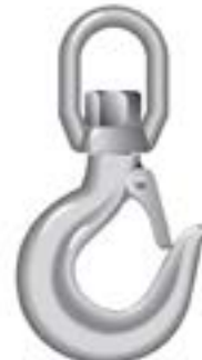
Gancho Giratorio Green Pin ECVB-P-6703 Material: Acero aleado, grado 8 Abertura: 20mm hasta 87mm Carga límite: Hasta 31.5 Ton Marca: Van Beest
