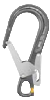
Mgo Open 60 MQPZ-MG0060 Conector direccional de gran abertura, bloqueo automático con punto de conexión Material: Aluminio Peso: 490g Abertura: 63mm Resistncia eje mayor: 23KN Marca: Petz
