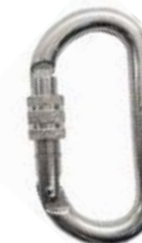
Oval Alu classic MQKG-7300001A1KK Mosquetón oval Sistema de Bloqueo: Screw-lock Material: Aluminio Color: Gris Peso: 65g Resistencia eje mayor: 22KN Marca: Kong
