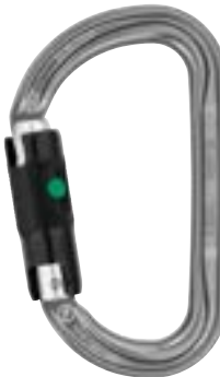
Am´D MQPZ-M34ABL Mosquetón asimétrico ligero Sistema de Bloqueo: Ball - lock Material: Aluminio Color: Gris Peso: 75g Abertura: 25mm Resistencia eje mayor: 27KN Marca: Petzl
